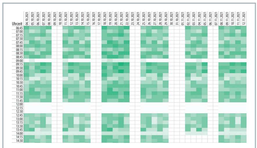
Bild 5. Heatmap (Auszug) zur genaueren Darstellung der FPY eines Teilprozesses. Quelle: ESSC-D © Hanser
